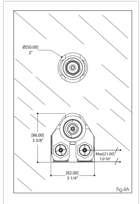
*Pour un entretien facile des composants mural de la valve après installation, l'ouverture doit respecter les cotes indiqués sur la fig.4A. Cela facilitera à l'accès pour le remplacement des cartouches et également pour tout les entretiens recommandés.*
